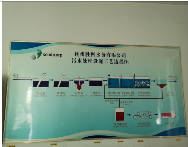
污水处理设施工艺流程图
